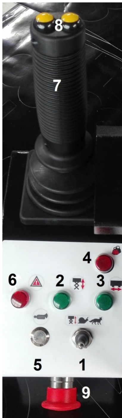
Рис 9 - Пульт управления на рабочей платформе (верхний пульт)**
